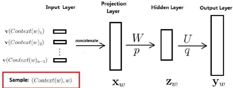
图 4 神经网络结构示意图
